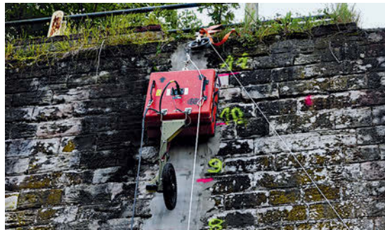
Bei ihren Untersuchungen nutzen die Wissenschaftler zerstörungsfreie und kontaktlose Verfahren wie das Georadar (links) und die Thermografie-Messung (unten).
